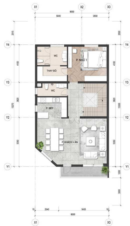
MẶT BẰNG TƯỜNG XÂY TẦNG 2 (DT: 110.3M2)
