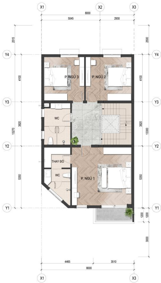
MẶT BẰNG TƯỜNG XÂY TẦNG 3 (DT: 108.0M2)
