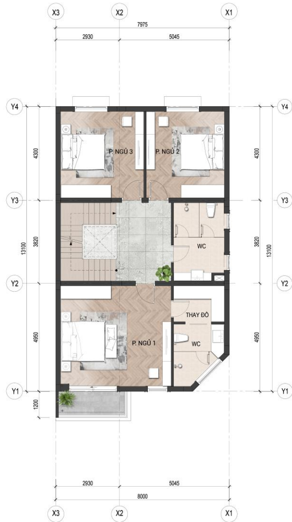
MẶT BẰNG TẦNG 3 (DT:107.3M2)
