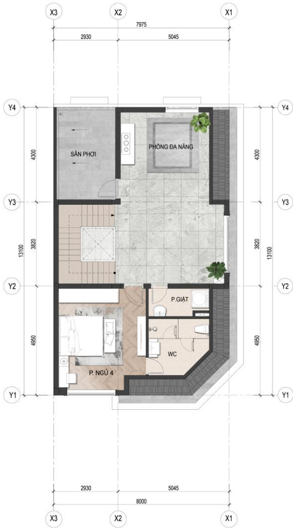
MẶT BẰNG TẦNG 4 (DT: 82.6M2)
