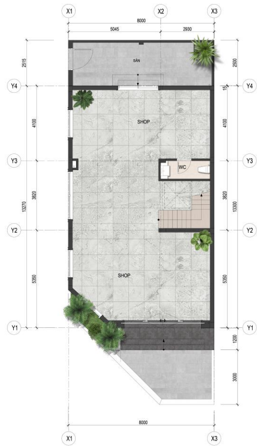
MẶT BẰNG TƯỜNG XÂY TẦNG 1 (DT:104.0M2)
